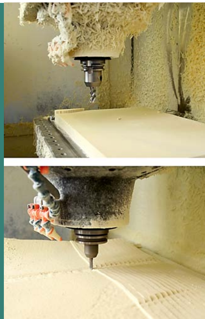
Erstellung des physikalischen Modells in der CNC-Fräse.
