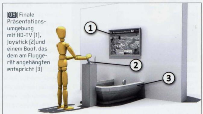
09) Finale Präsentationsumgebung mit HD-TV (1), Joystick (2) und einem Boot, das dem am Fluggerät angehängten entspricht (3)
