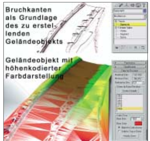
Erstellung eines Geländeobjekts auf Grundlage von Bruchkanten oder Höhenlinien (Shapes)
