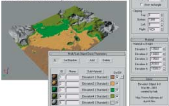
DEM-Import und Bearbeitung der Höhenkodierung mittels automatisch generiertem Multi-/Unterobjekt-Material
